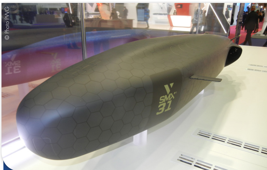
Le concept-ship SMX-31 de Naval Group est un sous-marin d'environ 3 000 tonnes en plongée, sans kiosque et recouvert d'écaillures en matériaux caoutchouteux incluant des capteurs.
