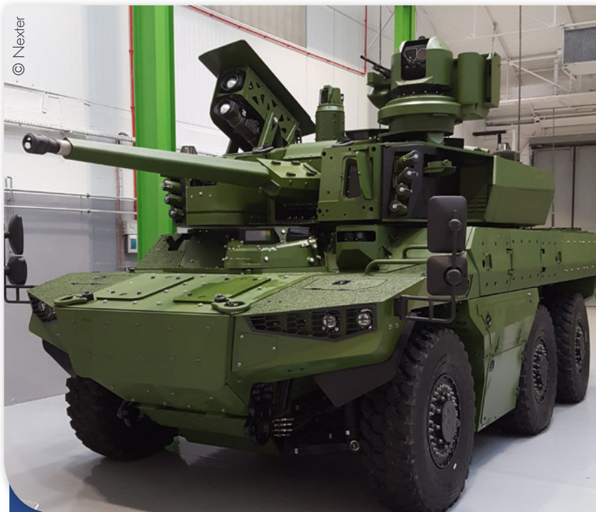
Fer de lance du programme Scorpion, le Jaguar est équipé d'un système de combat puissant, d'un ensemble optronique et d'un système d'information et de commandement qui démultiplie ses performances individuelles. 300 exemplaires sont prévus à l'horizon 2030.
