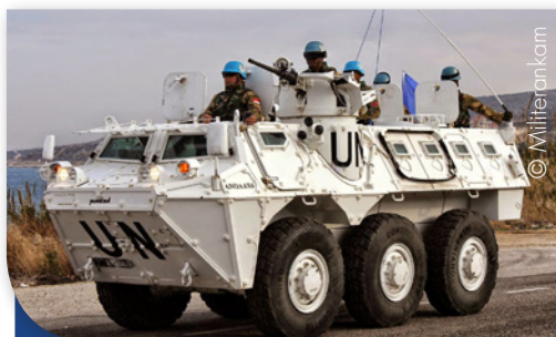
« Le véhicule de transport de troupe blindé ANOVA de l'Indonésien Pindad présente une forte ressemblance avec le VAB 6x6 français, lui-même acheté en 46 exemplaires par l'Indonésie ».
